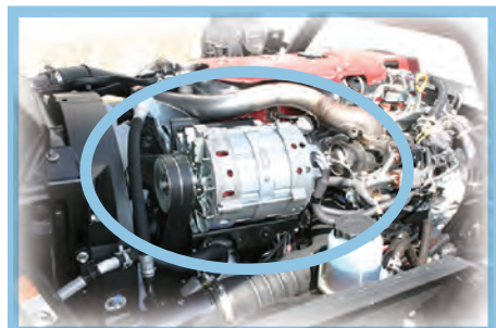
HMG 発電機 寸法概略 直径 160mm 長さ 244mm 重量 18kg
