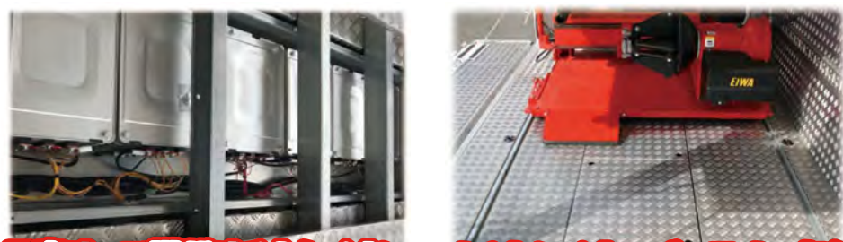
日産リーフ搭載リチウムイオンバッテリーモジュール組合せ例 リチウムイオンバッテリー収納部
