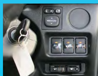
主電源・コンプレッサー・アイドルアップスイッチ例
