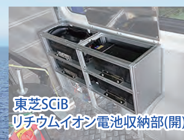
東芝SCiB リチウムイオン電池収納部(開)
