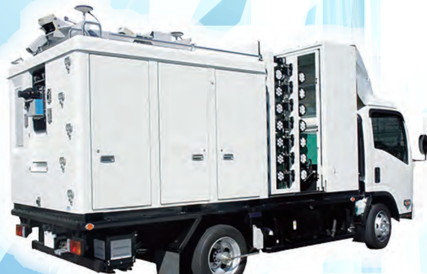
トンネル非破壊検査車「MIMM」
